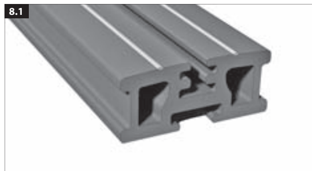
Высокий опорный профиль 80 x 35 мм Расстояния между опорными точками ≤ 600 мм. (см. 9.1)
