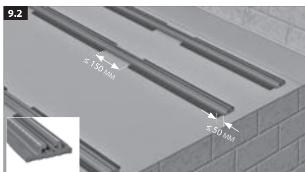
Допустимый вынос низкого опорного профиля – max. 50 мм.
