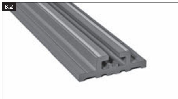
Низкий опорный профиль 55 x 17 мм Расстояния между опорными точками ≤ 150 мм. (см. 9.2)
