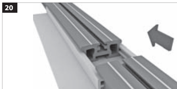
20 Уложить опорные профили встык. Анкер для плоских поверхностей использовать как соединитель.
